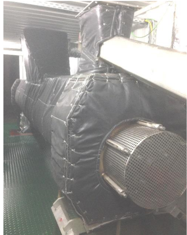
Abb. 3: Innenansicht 1 - Trocknungsreaktor mit Isolierung
